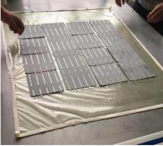
Şekil 3. Ayırıcı Film Üzerine Güneş Hücrelerinin Serilmesi
