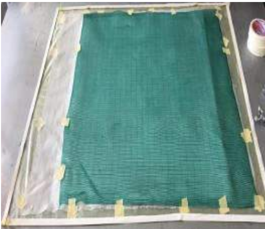
Şekil 5. Güneş Hücrelerinin Üzerine Cam Fiberlerin Serilmesi
