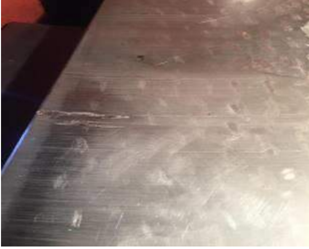
Şekil 3. Taşıyıcı yatak lokması beyaz metal deformasyon başlangıcı
