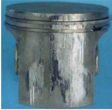
Şekil 3. Adhezyona maruz kalmış piston.
