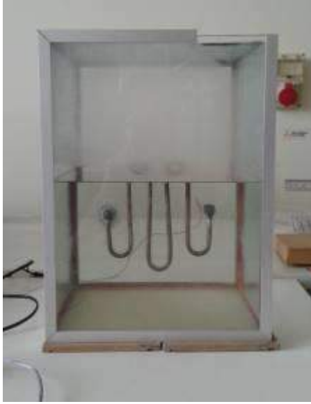
Şekil 4. Su Tankı Ve Rezistans Katı Hal Rölesi (SSR)
