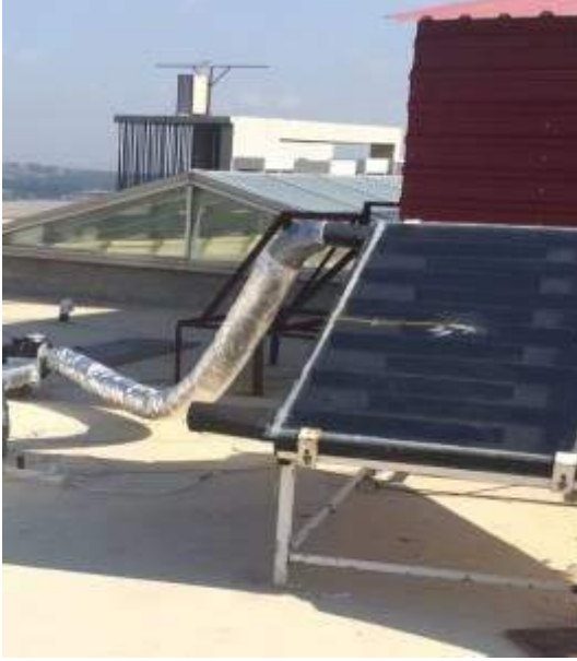
Şekil 2. Kanatçıklı havalı güneş kolektörünün son halinin görünüşü
