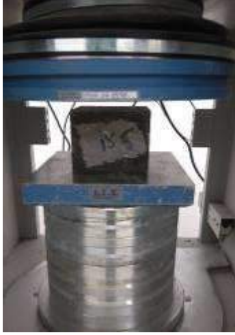
Şekil 2. Sertleşmiş Beton Testleri : a) Basınç Dayanımı, b) Dört Noktalı Eğilmede Çekme Dayanımı
