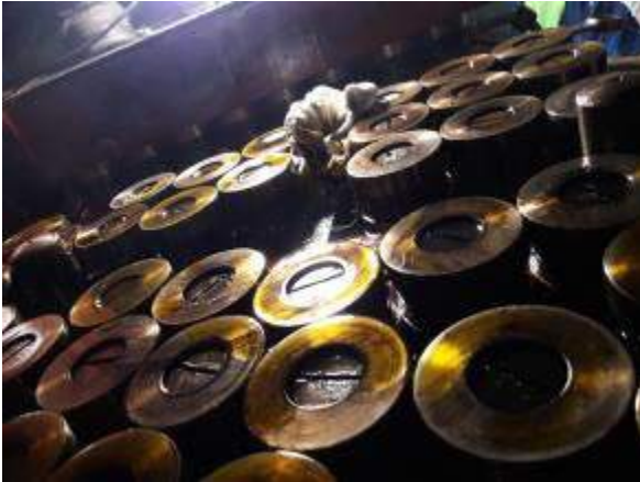
Şekil 4. Taşıyıcı yatak lokmalarında darbe emici yaylar
